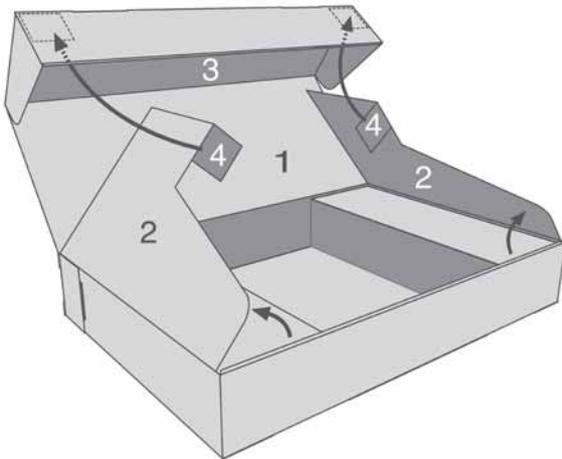
Um die Bühne zusammenzubauen, klappst du den Deckel [ 1 ] hoch und stellst die Seitenteile [ 2 ] aufrecht (festhalten). Dann klappst du die vordere Hälfte des Deckels [ 3 ] wieder nach unten. Dabei schiebst du die beiden kleinen Laschen [ 4 ] nach innen, so dass eine stabile Ablagefläche entsteht.
